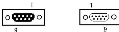
ATC-102-3V3 型转换器采用 DB9 型的母头连接器与 RS-232 接口相连, 其中 1、4、6
